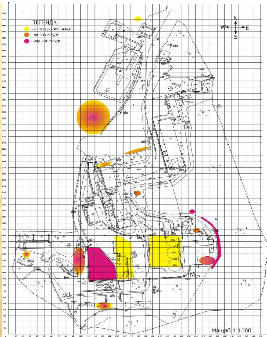
Схема 1 - Мрежа на измерване на мощността на дозата гама-лъчение на терена на завод "Звезда", с. Елешница
