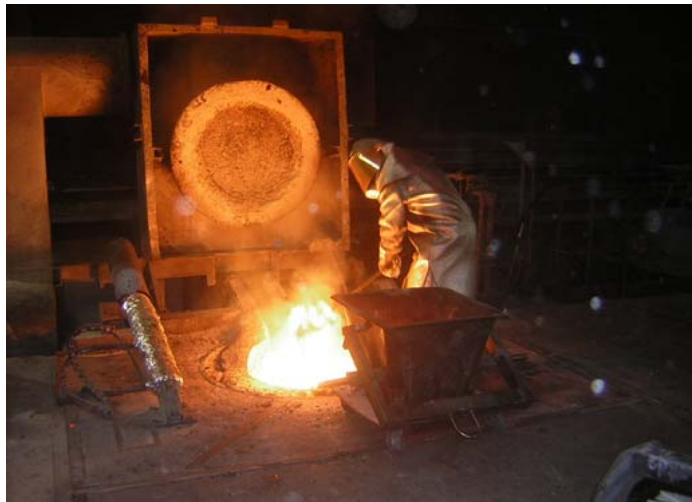
Separation of slag
